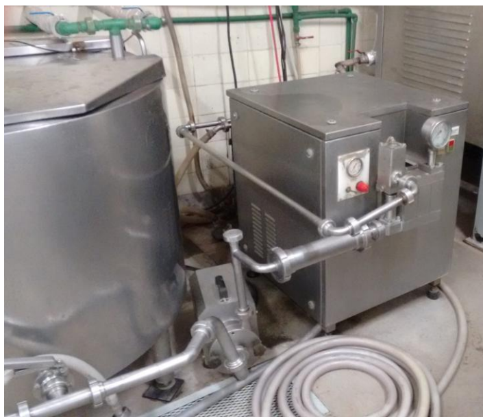
Figura 2. De izquierda a derecha: Segunda tina de cocción, bomba, filtro y homogeneizador.
